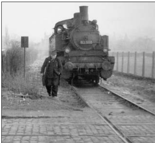
Güterzug 1954 auf der Wesselbahn mit Lok 92 566, Gleiskreuzung mit der Straßenbahn an der Endenicher Allee (im Vordergrund). Der Rangierer geht vor, um die Kreuzung mit einer roten Fahne für den Straßen- und den Straßenbahnverkehr zu sperren. Foto: Karl-Heinz Wipperfürth
